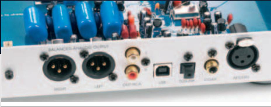
Das Anschlussfeld zeigt alle wichtigen digitalen Eingänge (von rechts nach links): AES/EBU, Koax, optischer Eingang und USB.
